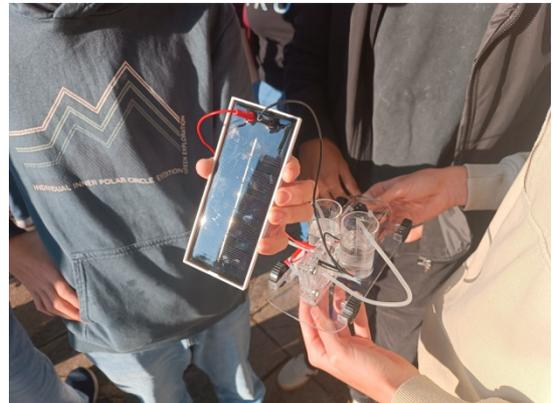
Wir haben zuerst zwei Messbecher mit Wasser gefüllt und diese dann auf eine vorgefertigte Stelle der Karosserie gestellt. Innerhalb der Messbecher ist eine Halbkugel, die ebenfalls Wasser beinhaltet. Das ist das Wasser, welches später geteilt und als Treibstoff verwendet wird. Der eine Messbecher speichert Sauerstoff und der andere Wasserstoff.
